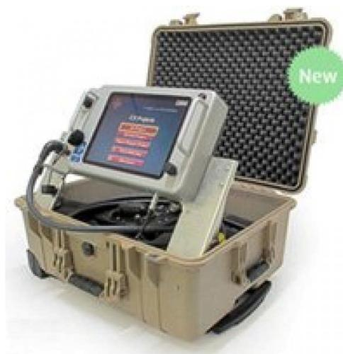
Il sistema MALA GPR CX Concrete Imaging consente di eseguire scansioni radar sulle strutture in calcestruzzo in modo semplice e sicuro ed attraverso il software integrato è possibile acquisire, visualizzare ed analizzare i dati in modo chiaro ed in tempo reale.
