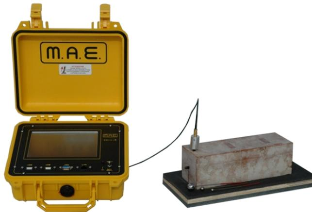
La strumentazione C311-R effettua il calcolo della frequenza di risonanza longitudinale, torsionale e flessionale su campioni di calcestruzzo o pietra naturale, per la determinazione del Modulo di Elasticità, del coefficiente di smorzamento e per analizzare il degrado dovuto ai cicli di gelo e disgelo del materiale da indagare.
