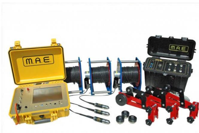
L'apparecchiatura A6000U rappresenta la soluzione più completa ed avanzata per verifiche strutturali non distruttive a mezzo ultrasuoni su fondazioni profonde, opere infrastrutturali o edifici-**E' conforme alle normative ASTM D6760-02, ASTM5882-00 e UNI EN12504-04.**
